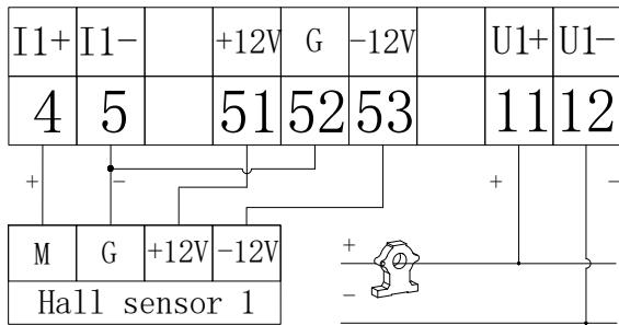
第一路直流输入 First DC input channel
