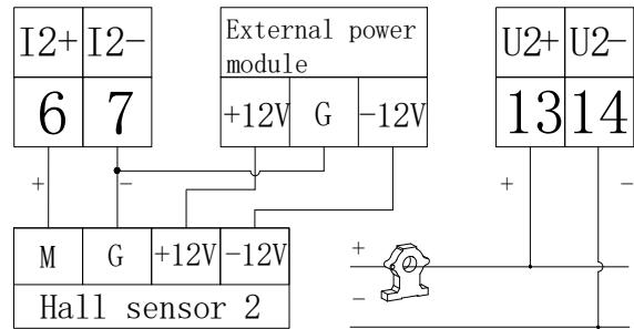
第二路直流输入 Second DC input channel
