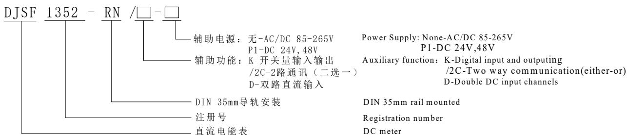
注:选配双路直流输入(D)功能时,如果电流通道均采用的是霍尔电流传感器输入,则需外配一个电源模块给第二路的霍尔传感器供电;如果未带D功能,则可使用电表内置电源。
