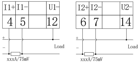
第二路直流输入 Second DC input channel
