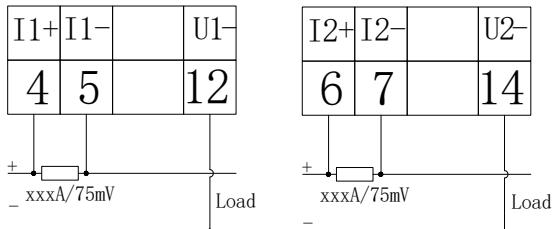
第一路直流输入 First DC input channel
